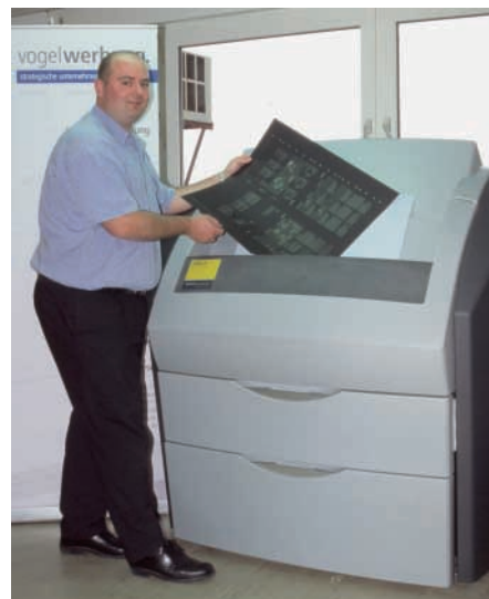
Claus Vogel am DPX-4-System. Bei der Auflösung mit 2 800 dpi bebildert er 30 Platten pro Stunde im Format der SM 52-5 P.
