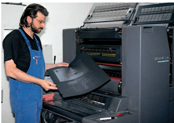
Drucker Dirk Frank beim Plattenwechsel. Der Platteneinzug erfolgt vollautomatisch, und die Plattenspannung ist in allen vier Druckwerken identisch.
