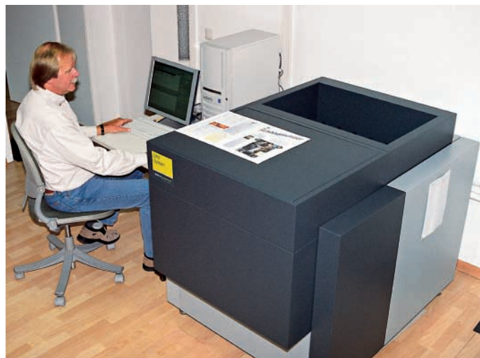
Vorstufenspezialist Manfred Weitzel am RIP-PC des DPX-Systems. Hier werden auch die Einstellungen für FM-Silverdot vorgenommen.
