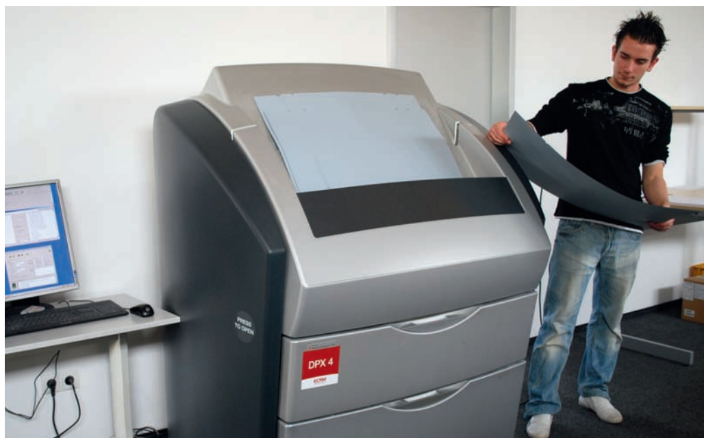
Der Polyesterplatten-Vollautomat DPX 4 hat zwei Materialrollen in der von den Optiprint-Druckmaschinen benötigten Breite im Zugriff. Die Platten werden automatisch auf die jeweils erforderliche Länge geschnitten und erhalten Stanzungen nach System Bacher. Für Maschinenbediener Alexander Richter bleibt da nur der gelegentliche kontrollierende Blick auf die Platte.
