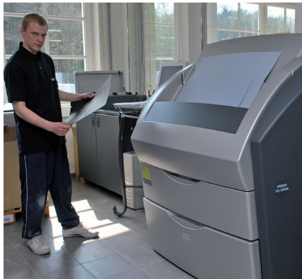
Der CTP-Vollautomat DPX 4 Eco von Mitsubishi bei der Druckerei Logitech (Ibbenbüren). Täglich wickelt man ca. 1000 Aufträge in kleinen Auflagen ab. Sie werden zum großen Teil in Sammelformen auf Heidelberg-Maschinen vom Typ SM 52-4 und SM 74-5 gedruckt.
