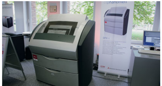
Das vollautomatische Polyesterplatten-CtP-System DPX 4 für das B2-Format aus dem Hause Mitsubishi.
