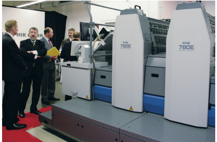
Die Besucher ließen sich die besonders kompakte Mittelformatmaschine Ryobi 784E demonstrieren. Die Maschine bietet eine 40-prozentige Platzersparnis und 28-prozentige Gewichtersparnis gegenüber der Ryobi-750er-Serie. Dabei blieben Fortdruckleistung – 15 000 Bogen pro Stunde – und die Druckqualität unberührt.
