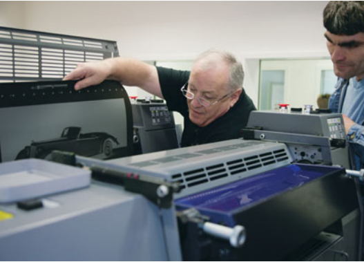
Bernd Schmitt, Mitsubishi-Produktspezialist für CtP-Druckplatten, beim automatischen Platteneinzug der Polyesterplatte an der Ryobi 524GX.
