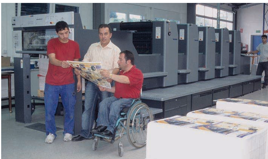
Geschäftsführer Mustafa Kaya (Mitte) und technischer Leiter Talat Kaya (rechts) mit Azubi Ferhat Alemdar an der neuen Speedmaster SM 74-5. Bis zu 45 000 Exemplare auf gestrichenem Papier wurden bereits mit einem Plattensatz Silver Digiplate gedruckt.
