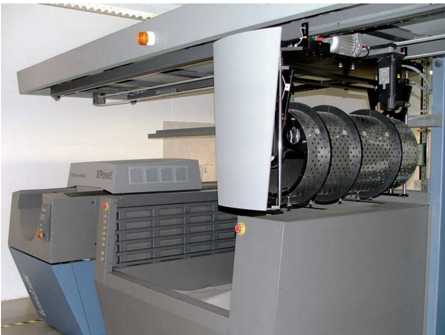
Die CtP-Systeme der Serie Xpose UV Conventional des Schweizer Herstellers Lüscher bebildern herkömmliche Analogplatten mit Violett-Laserdioden (im Bild: ein Xpose 130 UV Conventional mit 64 Laserdioden und Plate Handling System (PHS), im Einsatz beim Etikettenspezialisten Walcher & Rees GmbH in Heidenheim).
