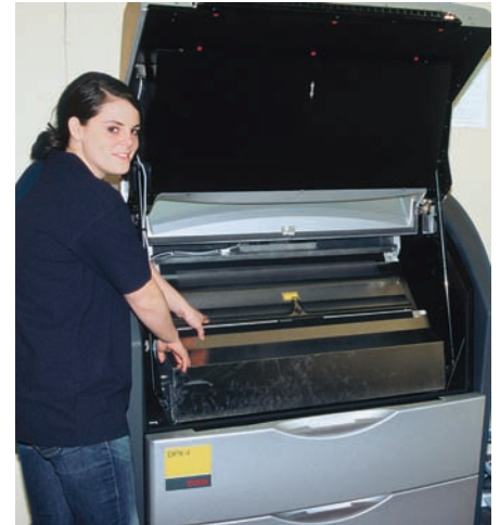
Im Vollautomaten DPX 4 stehen zwei Magazine für die Aufnahme von Silver Digiplate mit Rollenlängen von 61 m zur Verfügung.
