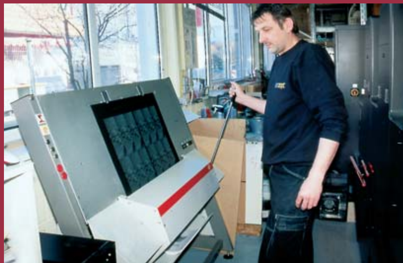
Heidelberg-Maschinen ab dem Format B2 verlangen eine Plattenabkantung. Kein Problem mit einem thermischen Abkantgerät von Bacher.
