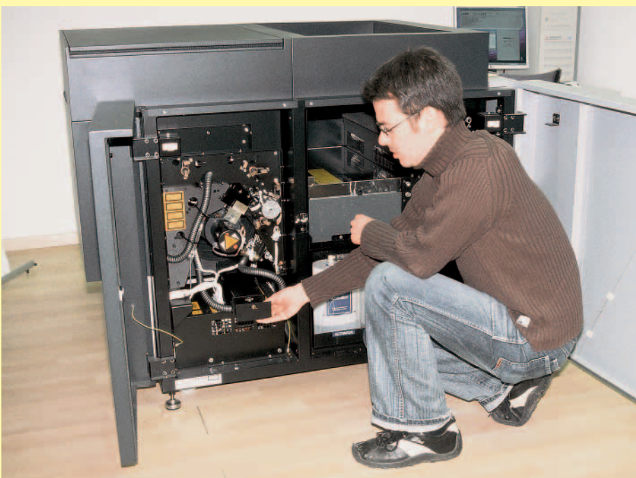
Teil des DPX-Innenlebens. Auf der linken Seite die Bebilderungssektion mit der Innentrommel, rechts Aktivierung und Stabilisierung. Die Chemie wird etwa alle vier Wochen gewechselt. Ein Kanal- und Wasseranschluss ist nicht erforderlich.
