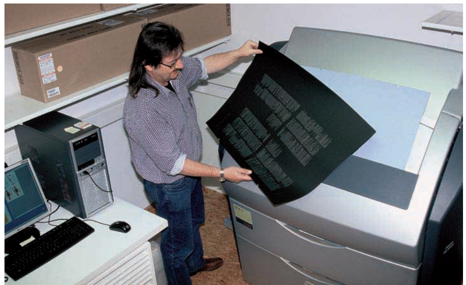
Der Handlingsaufwand am DPX-4-Vollautomaten beschränkt sich auf das Entnehmen des gesamten Plattensatzes. Werden Platten in der Spätschicht benötigt, startet ein Drucker die Bebilderung.
