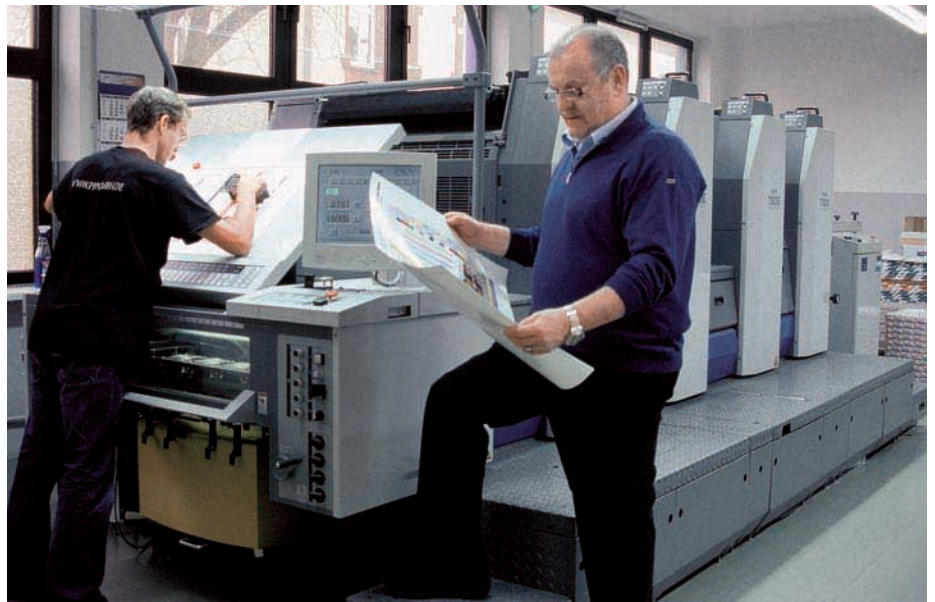
Drucker Marc Hör und PPP-Geschäftsführer Norbert Ambos (r.) an der Vierfarben Ryobi 784 EP mit Wendung. Nach weniger als sechs Monaten hatte die Maschine bereits über zehn Millionen Drucke auf dem Zähler.
