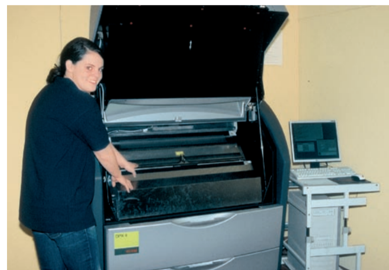
Im Vollautomaten DPX 4 stehen zwei Magazine für die Aufnahme von Silver Digiplate mit Rollenlängen von 61 m zur Verfügung.
