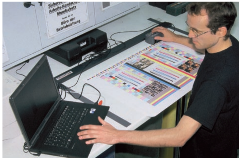
Drucker Marc Hör kontrolliert die gleichmäßige Farbführung mit einem Spektral-Densitometer
