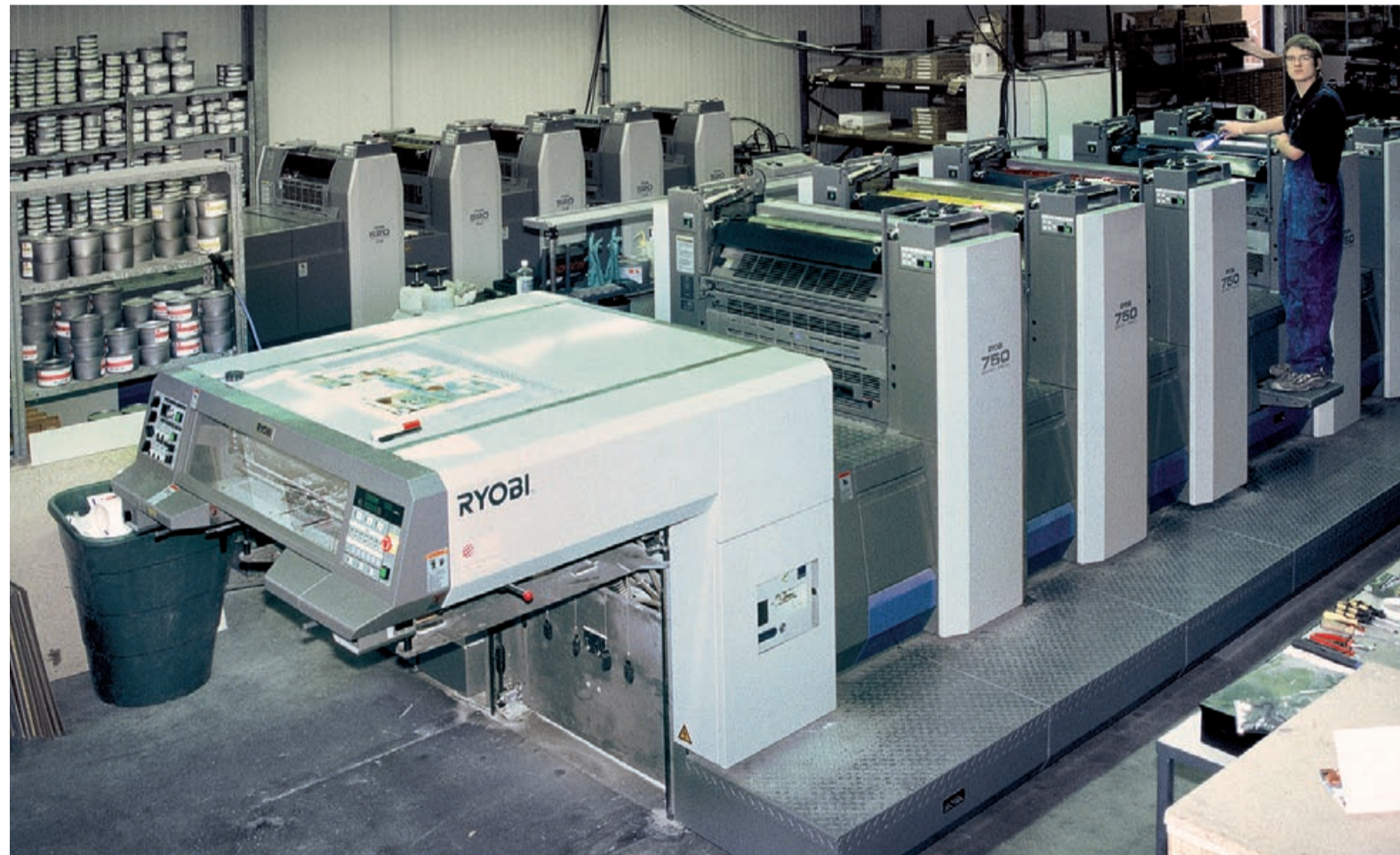
Bereits nach einem Jahr reichte die Druckkapazität der Ryobi 525 GX (hinten) nicht mehr aus, zusätzlich wurde in eine Ryobi 755 P investiert: Die Fünffarben Ryobi 755 P ist bei C+S-Druck mit einer Wendung nach dem zweiten Druckwerk ausgestattet.
