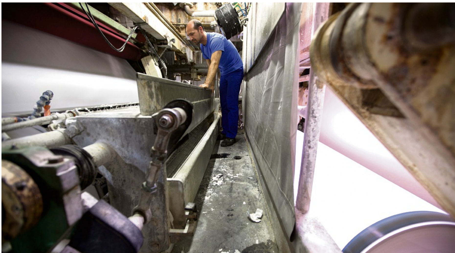
Das Spezialpapier entsteht in 2,40 Meter breiten Bahnen und läuft über 28 tonnenschwere Trockenzylinder Maschinenführer Michael Siebert
