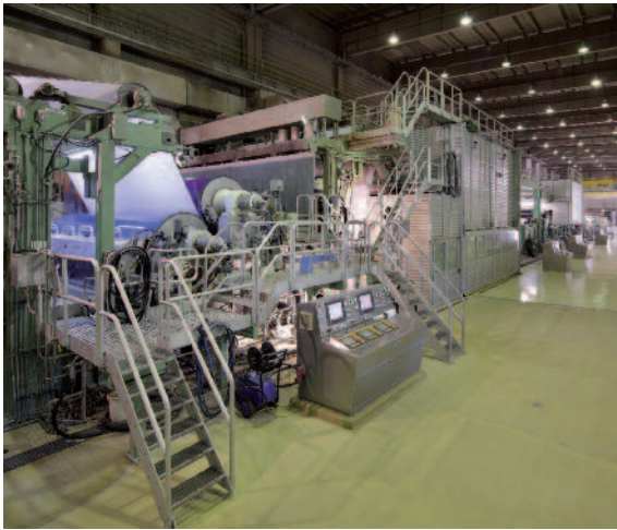
Die Papiermaschine (PM) 3 produziert mit einer Geschwindigkeit von bis zu 1.100 m/min. Foto: Mitsubishi HiTec Paper Europe GmbH
