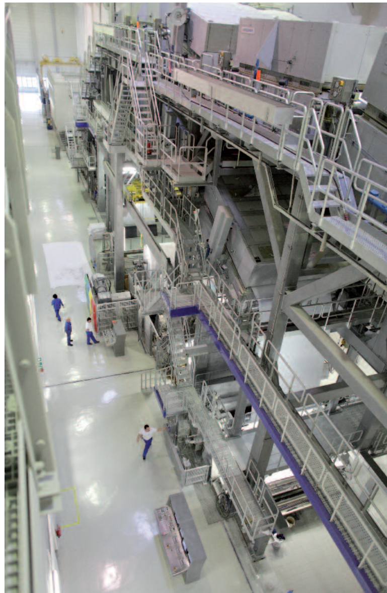
Giganten sind auch die Streichmaschinen. Hier werden die Rohpapiere mit den jeweiligen Funktionsstrichen für Inkjet-, Selbstdurchschreibepapier, Thermo- und Etikettenpapieren beschichtet (»Strich«).
